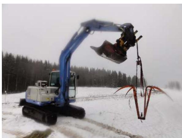
Figur 11. Pilotförsöket med skörd av flytmassor i Långsjön utfördes med hjälp av en gripklo avsedd för hö monterad på en grävmaskin. Ca 3 m 3 togs upp. Foto: Östen Holmström.
